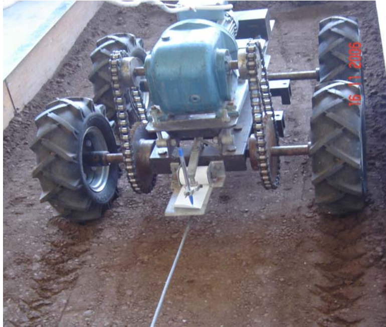
Εικόνα 5. Ομοίωμα τροχοφόρου ελκυστήρα κατά τη διάρκεια των δοκιμών.
